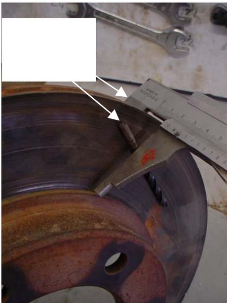
A l'aide d'un pied à coulisse et 2 de mèches de diamètre identiques (cf. photos), après avoir nettoyé le disque avec un chiffon et en faisant attention au rebord dû à l'usure.
