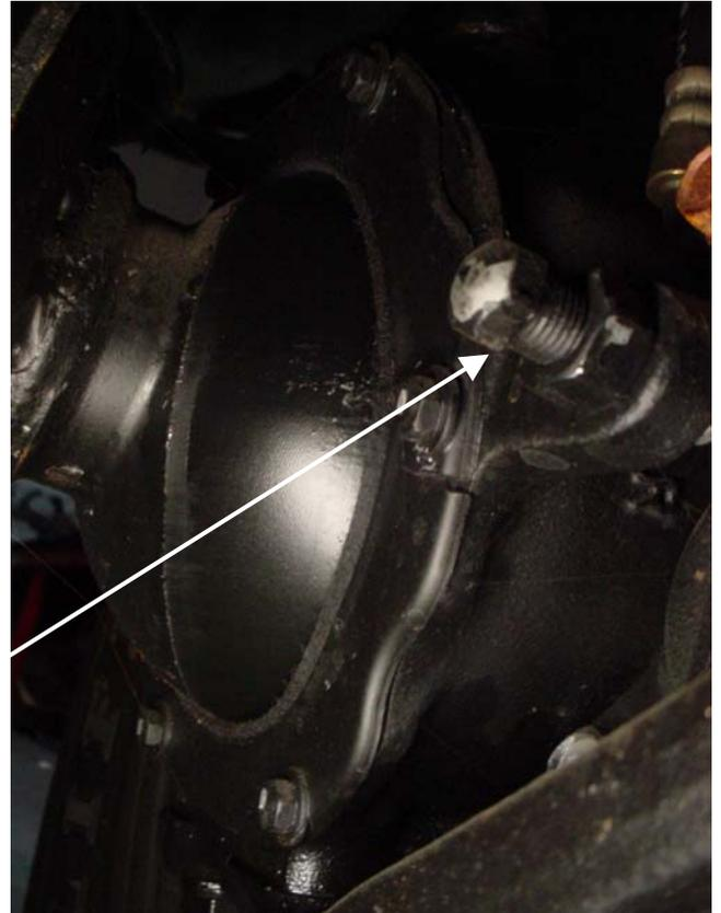
Il faut tourner le volant à fond à gauche et à droite et s'assurer que les 4 butées de direction sont bien en contact avec le pont.
