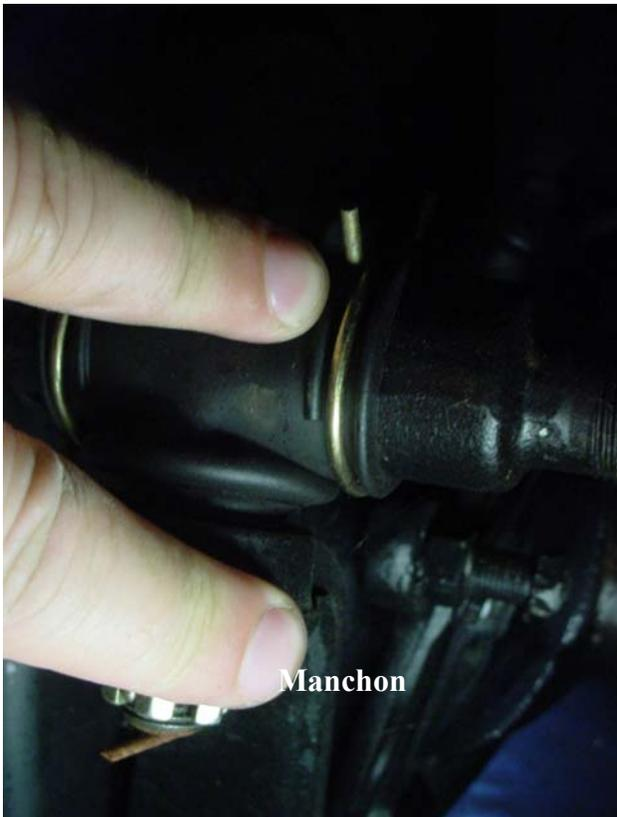
Il faut 2 personnes pour mesurer le jeu: l'une tourne le volant alternativement de gauche à droite tandis que l'autre, sous le véhicule, vérifie avec 2 doigts, le lien entre partie menante et partie menée sur chaque rotule (cf. photo).
