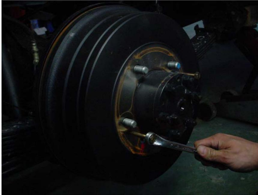
Après la dépose, il convient de vérifier l'état et l'usure des tambours. Si ces derniers présentent une usure irrégulière et/ou importante, il faut changer les tambours.
